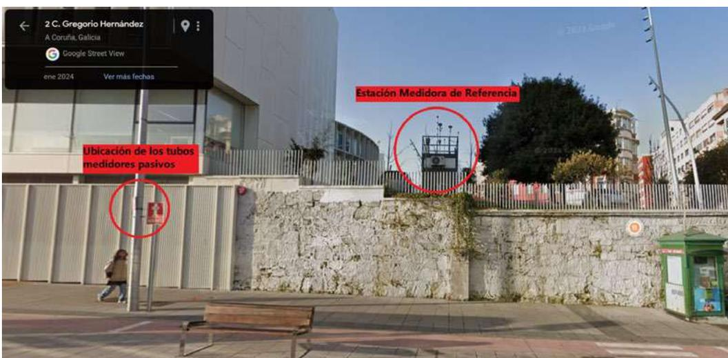
Las instrucciones de colocación de tubos pasivos, indican que para una correcta medición del  $\text{NO}_2$  la ubicación ideal de los tubos sería a la altura media de las vías respiratorias de una persona, pero para evitar la curiosidad de los viandantes y la pérdida de los tubos medidores, se recomienda colocarlos a unos 3 metros de altura, y se puntualiza que la concentración de  $\text{NO}_2$  será menor cuanto a mayor altura se coloquen los tubos.
