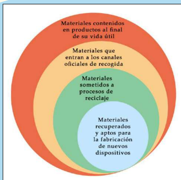
Figura 18: Representación esquemática de las pérdidas de materiales en el proceso de recuperación a partir de productos al final de su vida útil.E.
