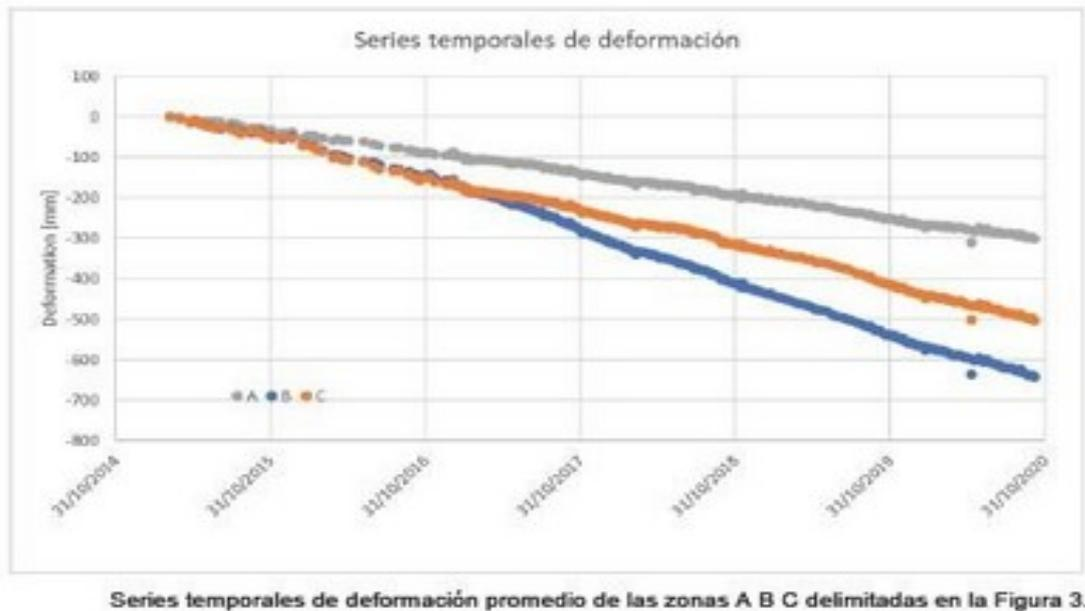
Figura 3.3.- Series temporales de hundimiento promedio de las zonas A, B y C en el sector del apilamiento 2.
